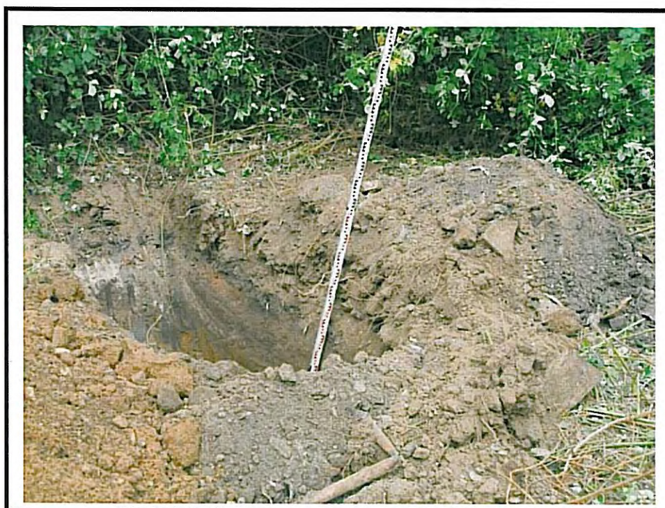
Bild 6: Schurf 17, ausgehobene, oberflächlich vorhandene Brandrückstände
