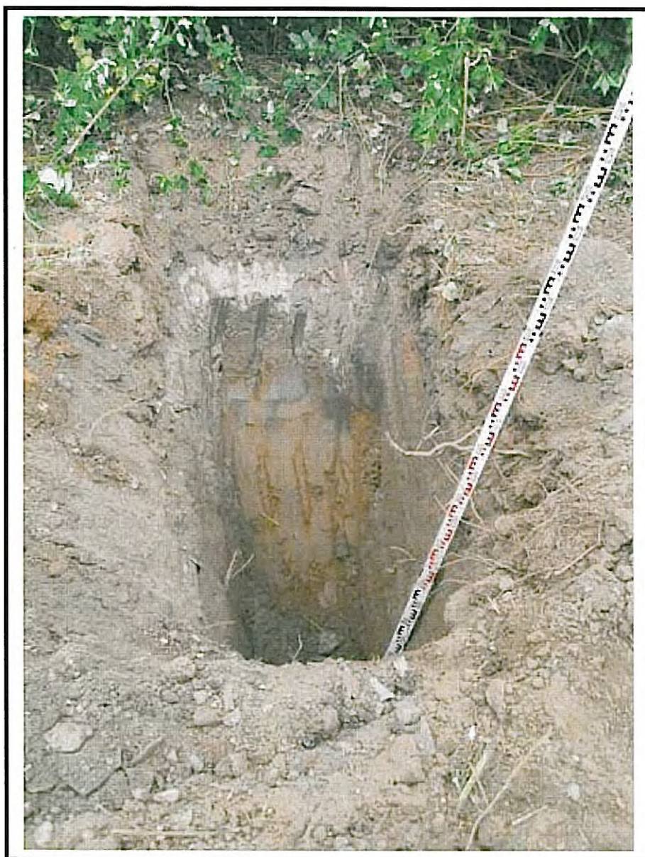
Bild 7: Schurf 17, anstehender Hochflutlehm über Terrassenkies überlagert von Auffüllung mit Brandrückständen
