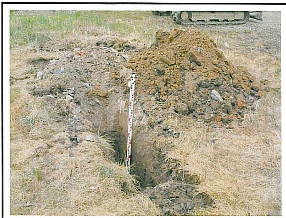
Bild 5: Schurf 27, oberflächlich Schotter mit Teeranhäufungen
